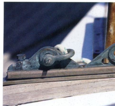
Ci-dessous et à gauche : L'emmagasineur de drisse de grand voile et le rail d'écoute sont de belles pièces de collection.
